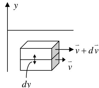
$$\text{故: } f = \eta \Delta A \underbrace{\frac{dv}{dy}}_{\text{速度在 } y \text{ 方向上的梯度}} \quad \eta: \text{比例系数, 粘滞系数, 单位: } N \cdot s/m \text{ 或 } Pa \cdot s$$
